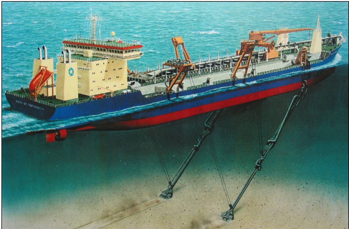
Abb. 5: Arbeitsweise eines Hopperbaggers
